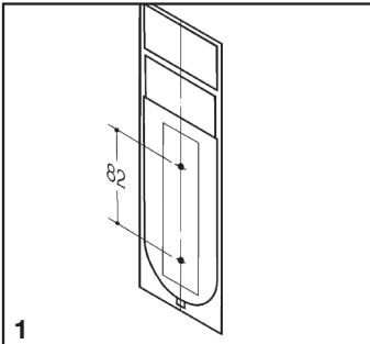
**D** Anreißschablone an Mittellinie ausrichten. Bohrpunkte anzeichnen. Achtung: Abmaße des Seifenspenders beachten.
